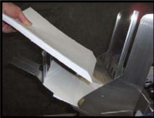
Beim Auffüllen eines leeren Magazins: Legen Sie ein Druckmedium ein, sodass es direkt an den Kuppen der Papiertrenner anliegt.
