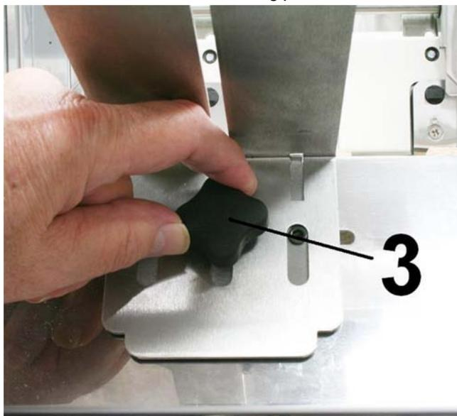
4. Installieren Sie das gewünschte Vorsatzteil für die Druckmaterialstütze mit dem Montagezubehör [4].
