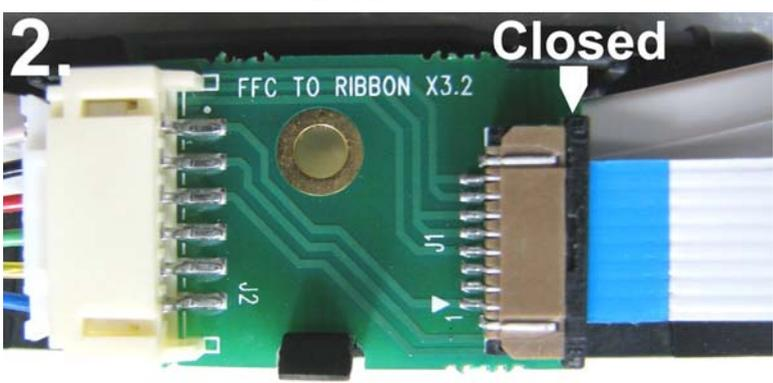
8. Nachdem das Flachbandkabel ordnungsgemäß an die Platine der Servicestation angeschlossen ist, schieben Sie die Servicestation mit der Abstreifwalze vorsichtig bis zum Anschlag in den Einschub der Servicestation. Die Servicestation passt in den Einschub, der sich direkt über den Einschüben für die Tintenkartuschen befindet.
