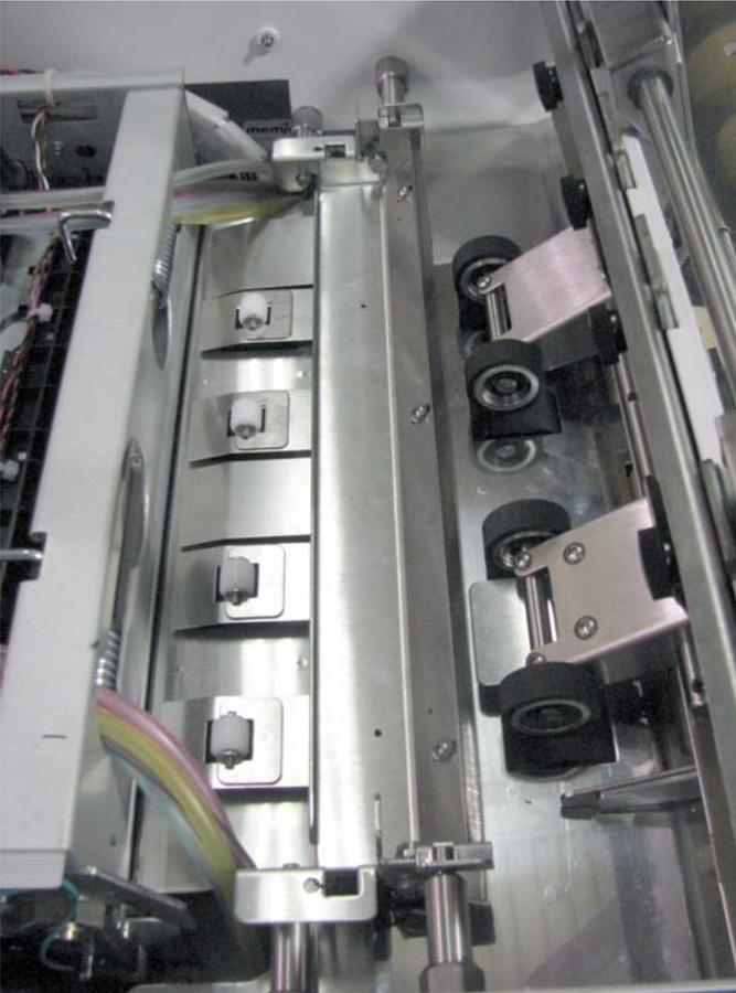
Über den Drucksystembereich: Öffnen Sie die obere Abdeckung. Heben Sie die beiden Verschlüsse an (einer auf jeder Seite der Drucksystemeinheit), und klappen Sie dann die Drucksystemeinheit [C] nach oben. Beseitigen Sie den Stau, und senken Sie die Drucksystemeinheit dann ab, wobei die Verschlüsse wieder einrasten müssen. Schließen Sie dann die obere Abdeckung.
