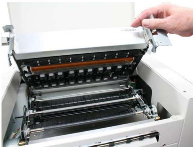
Öffnen Sie die Drucksystemeinheit NICHT über einen Winkel von 60° hinaus. Dadurch können die Tintenfarbleitungen beschädigt werden und andere Probleme auftreten.
