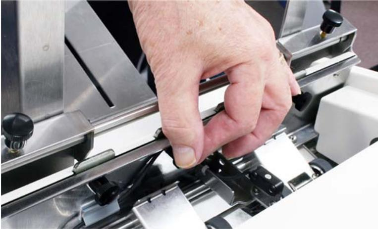
4. Legen Sie ein einzelnes Druckmedium zur Verarbeitung unter die Papiertrenner. Legen Sie das Material immer an der Seitenführung der Druckmaterialregistrierung an.
